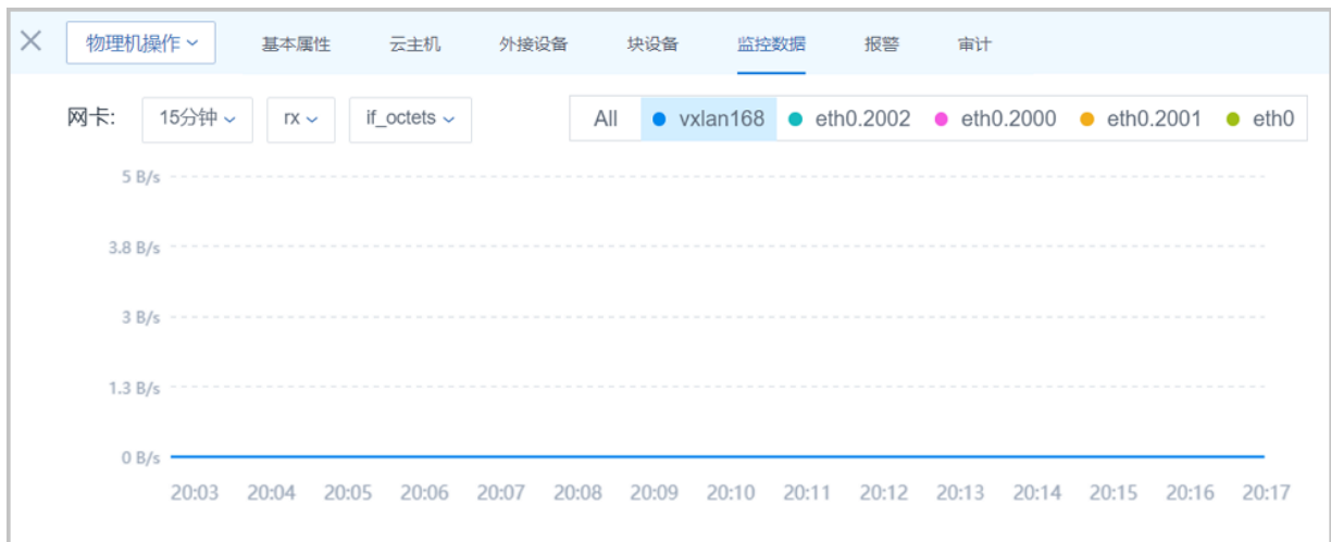
图 214: 网卡实时监控
